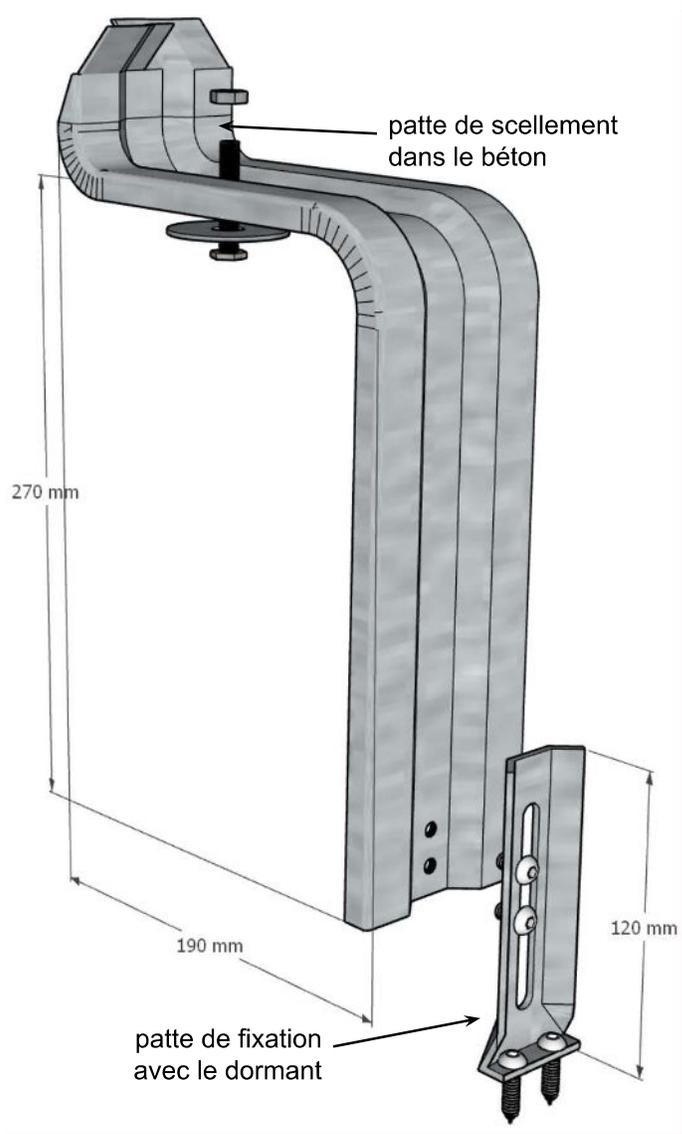
**Renfort en acier galvanisé 3 mm avec scellement dans le linteau et pattes de fixation**
