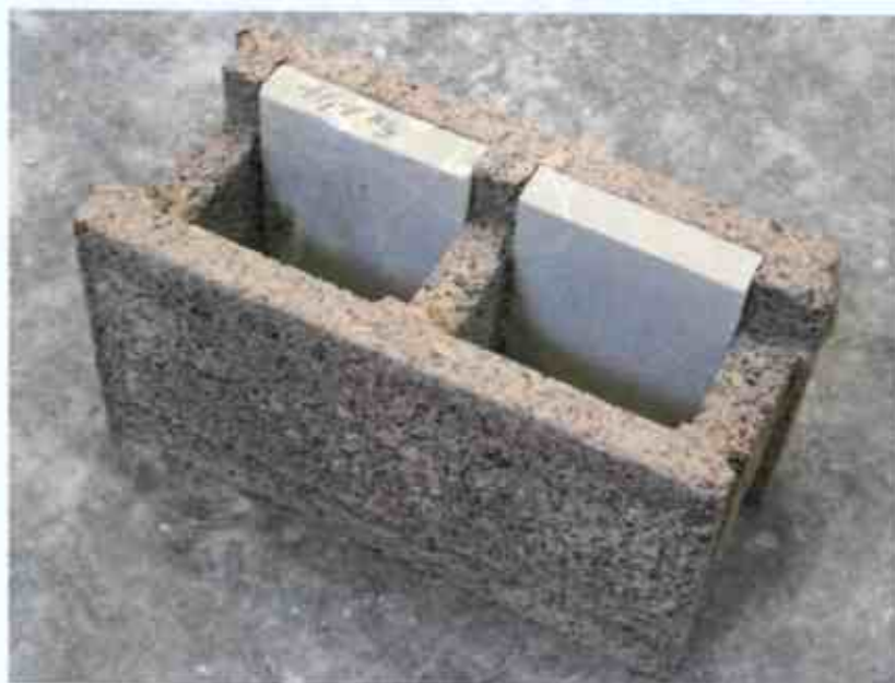
Fotografie del blocco cassero utilizzato per la realizzazione del campione.
