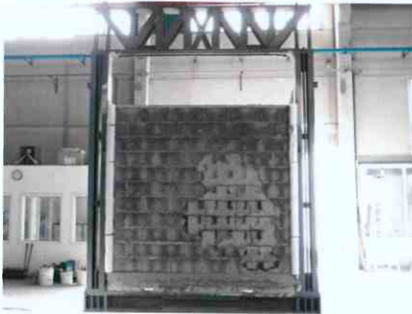
Fotografia della faccia esposta al fuoco del campione dopo la prova.
