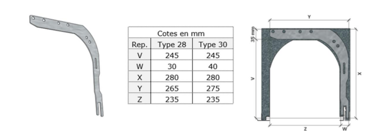
Figure 24 - Renfort en acier galvanisé pour coffres renforcés
