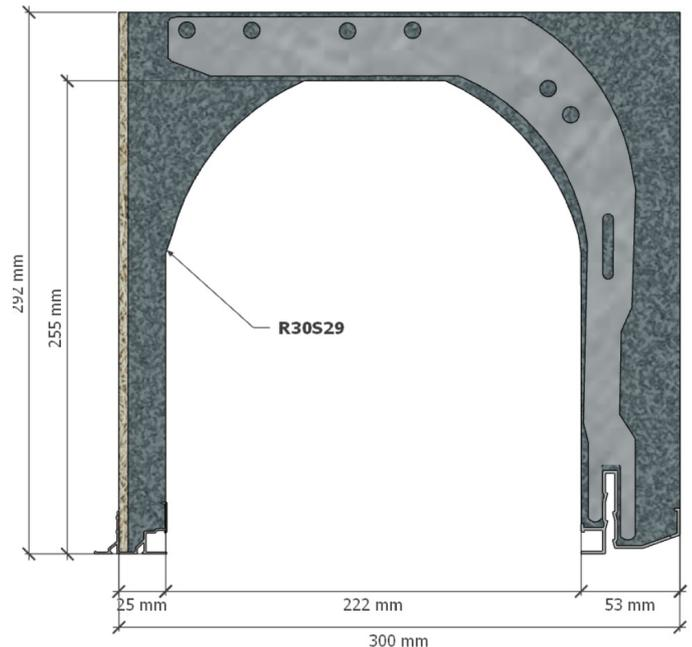
**Option équerres et ligatures [PDF]** : conformément à l'avis technique du CSTB, les coffres renforcés seront ligaturés au chaînage et fixés à la traverse haute au mouen d'équerres. Equerres et ligatures sont livrables en paquet de 500 pièces ou intégrées dans le coffre à la production.
