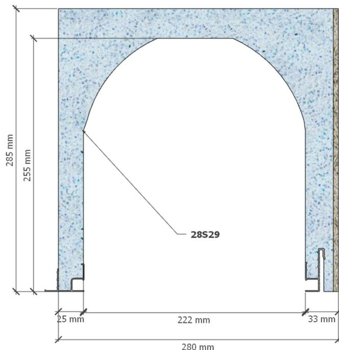
**Option cornière [PDF]** : les rails 8E permettent l'ajout du cornière d'étanchéité et de fixation avec la menuiserie. Ces cornières crantées de 40x30 mm sont livrables en paquet de 100 pièces ou insérées dans le coffre.
